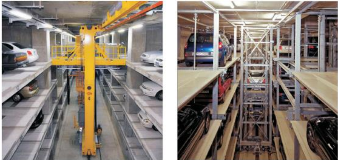
Hình 2.12. Mô hình hệ thống thang nâng di chuyển
