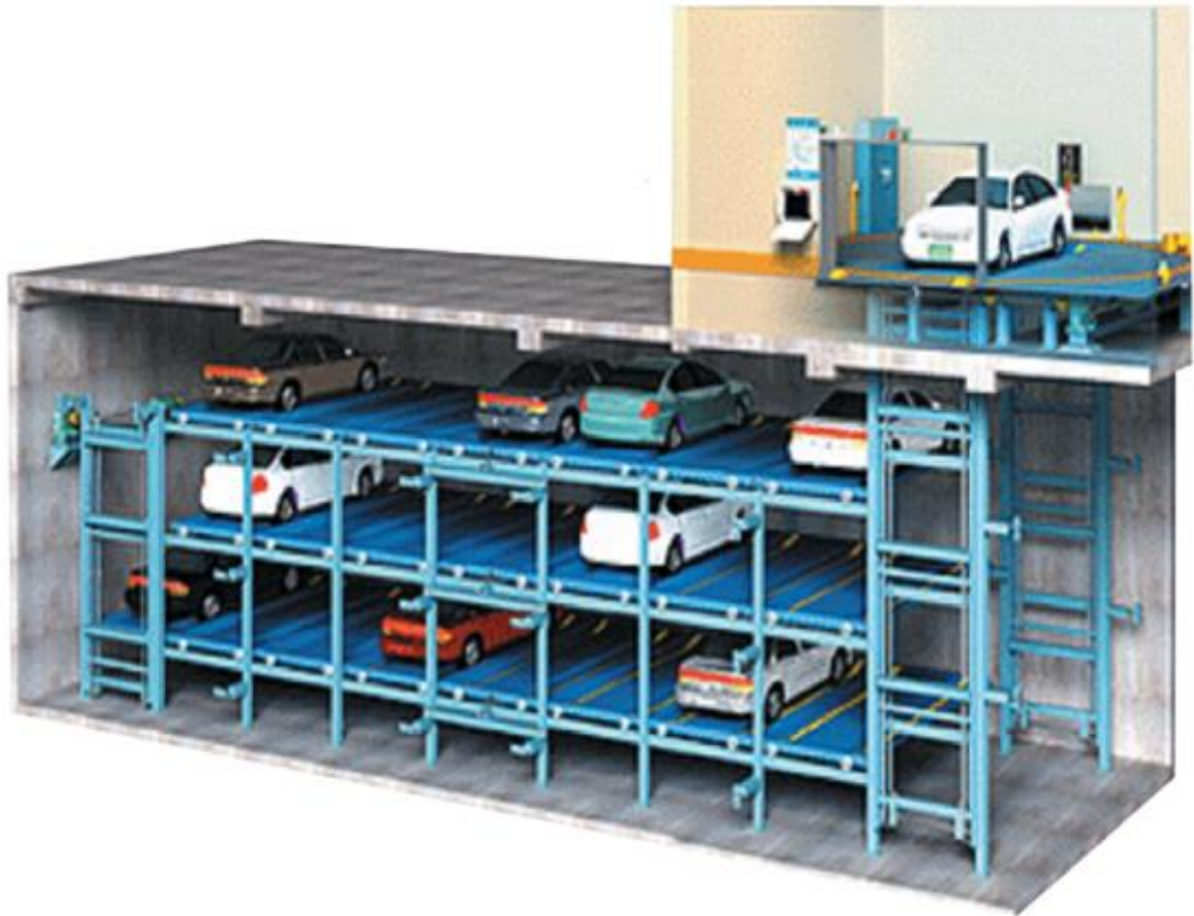
Hình 2.5. Mô hình hệ thống xoay vòng tầng
