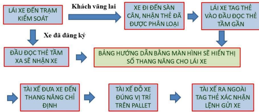
Hình 3.16. Thao tác lái xe vận hành đưa xe vào hệ thống
