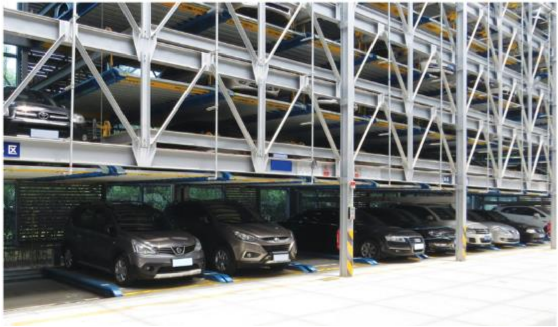
Hình 2.8. Mô hình hệ thống nâng, trượt ngang
