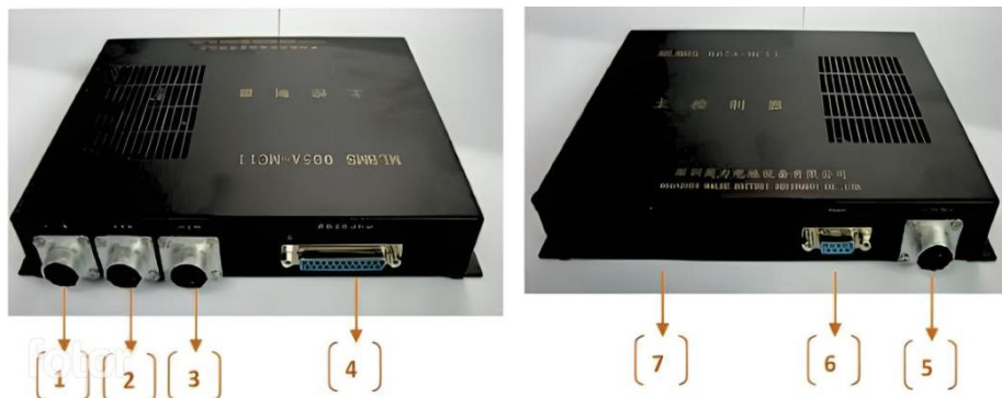
Hình 3.14: Bộ điều khiển chính BMS [28]
