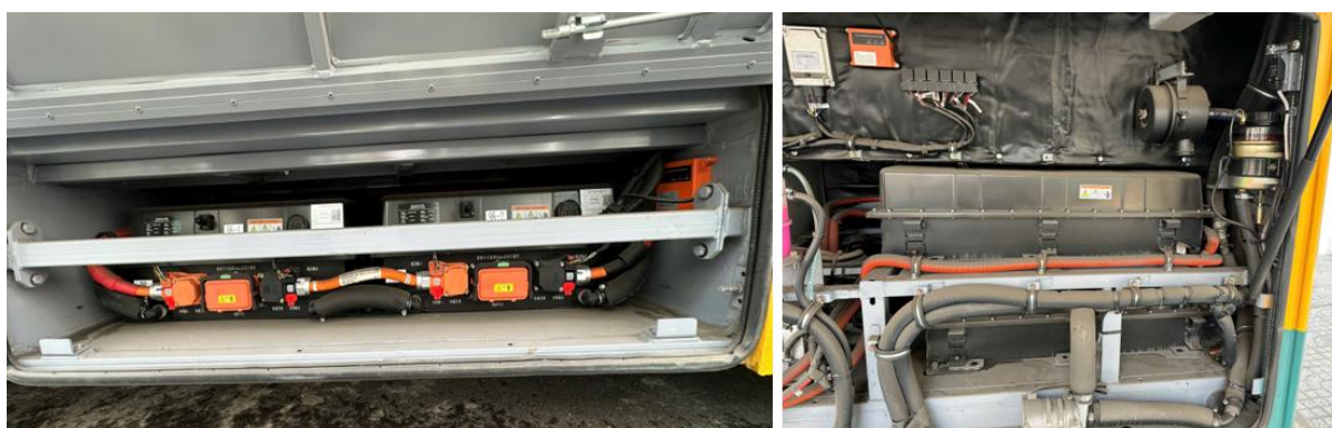
Hình 1.14: Bộ pin bố trí trên xe Kim Long B30
