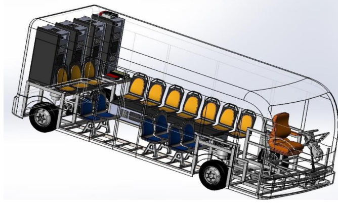
Hình 3.23: Khối pin bố trí phía sau và dưới ghế hành khách
