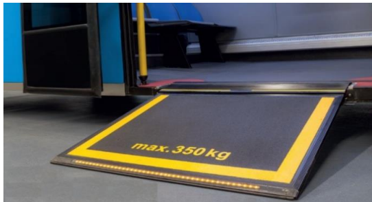
Hình 3.5: Cầu lên xuống cho xe lăn
