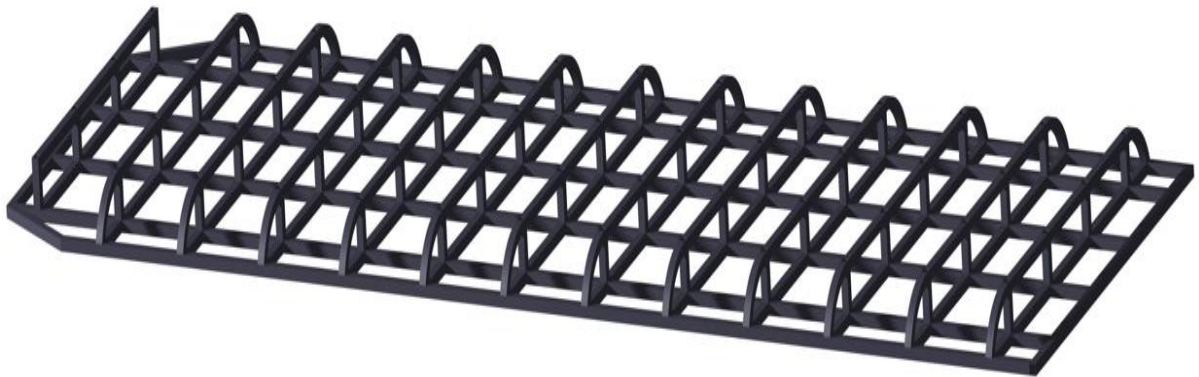
Hình 3.5. Bản vẽ 3D của phần khung mũi xe buýt điện sử dụng trong đề án.
