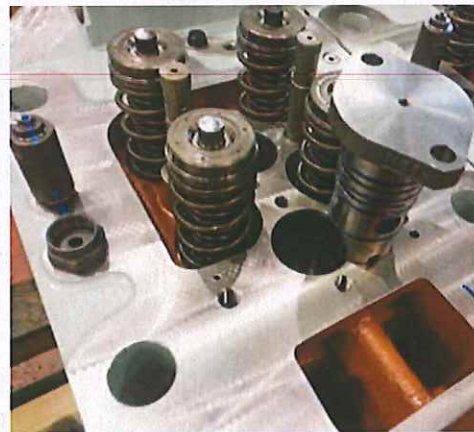
Hình 2.8. Van khởi động trên xilanh (Cylinder starting valve)
