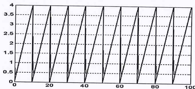
Hình 4.9 Đáp ứng ngõ ra \theta_2 với tín hiệu đặt là xung răng cưa
