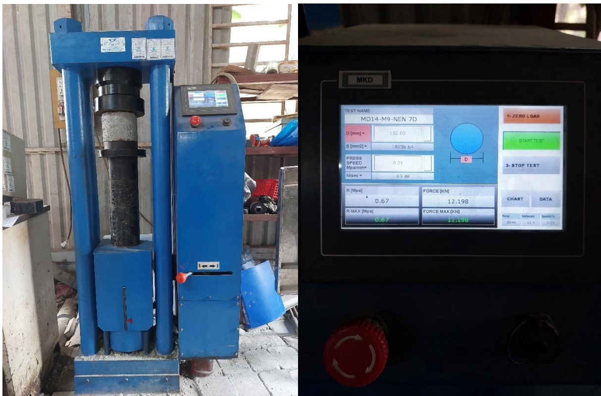
Hình 2-15: Thí nghiệm xác định cường độ chịu nén
