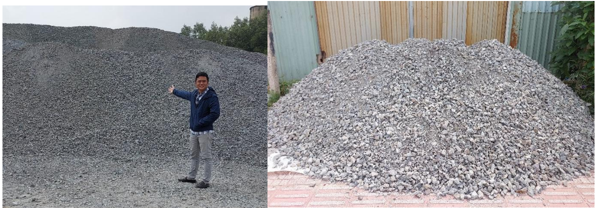
Hình 2-1: Hình ảnh đi lấy mẫu và tập kết cấp phối về phòng thí nghiệm
