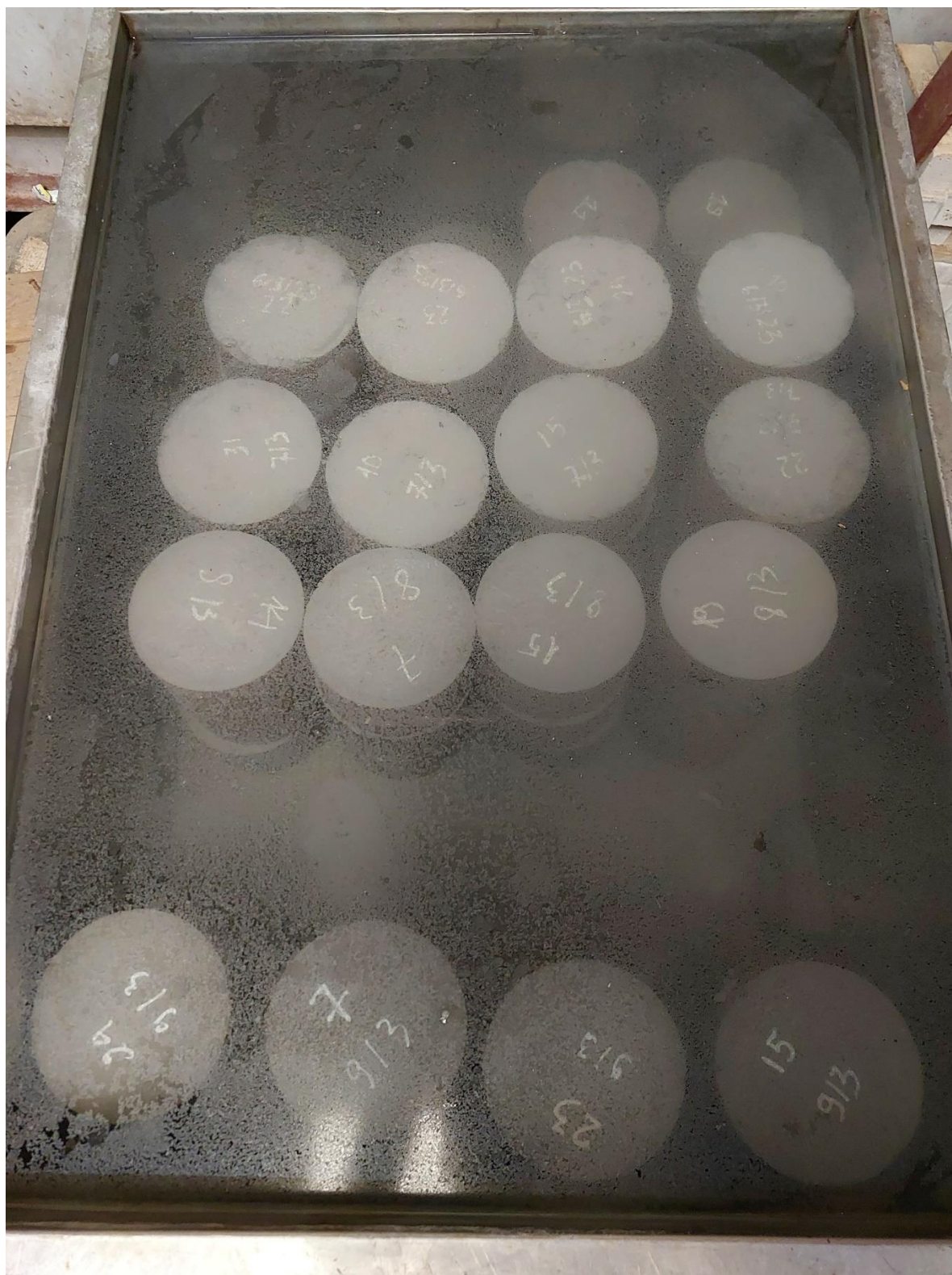
Hình 2-14: Ngâm mẫu cấp phối đá dăm gia cố xi măng trong nước
