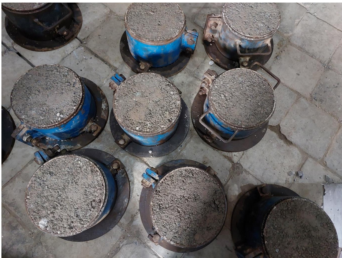
Hình 2-13: Mẫu sau khi đầm để thí nghiệm xác định cường độ chịu nén và cường độ chịu kéo khi ép chẻ của cấp phối đá dăm gia cố xi măng
