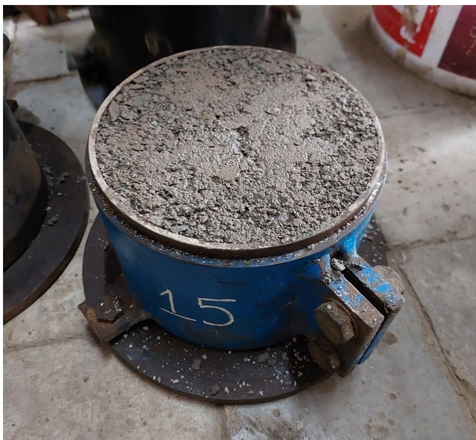
Hình 2-10: Mẫu thí nghiệm sau khi đầm
