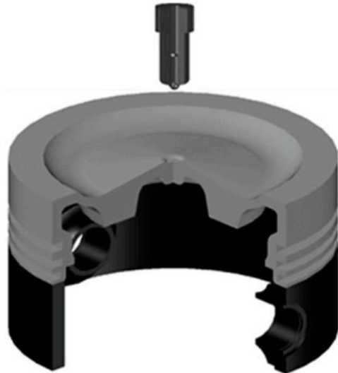
Hình 3.5 [4]: Hình học 3D cắt một phần tư của piston và vòi phun nhiên liệu thí điểm.
