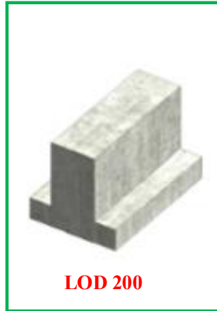
Hình 1-5: Mức độ phát triển BIM-LOD 200
