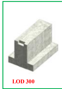
Hình 1-6: Mức độ phát triển BIM-LOD 300
